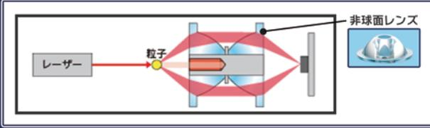
【迷光対策】粒子が無い場合、レーザー光が直進し吸収体により迷光（ノイズ）を抑える構造となっており、受光センサに余計な光が入らないため低濃度の測定を可能にしました。
